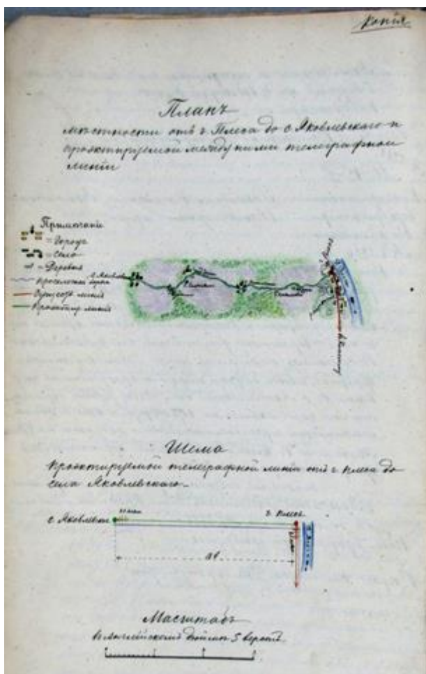
Схема проектируемой телеграфной линии от г. Кинешмы до г. Пlesa. (Государственный архив Вологодской области. Ф. 1164. Оп. 2. Д. 18. Л. 22)
